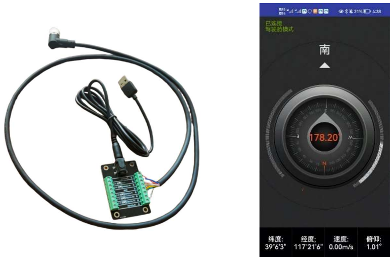
(注：左图为 M12 航空插头转 RS232/RS422 分线端子，右图为北斗卫星罗经 APP 主界面)
